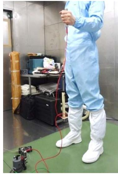
図 9.4 歩行帶電測定例(クリーンツナギ/ブーツ着用)
