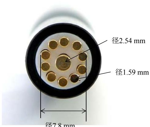
図 10.7 同心円リング型マイクロプローブ（PRF-914B）
