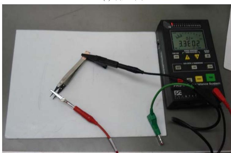
図8.3 金属ハンドルピンセットの表面抵抗の測定例
